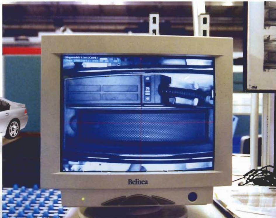
Komplettcheck auf Knopfdruck: Nach dem Einlegen des Prüfteils in die Aufnahmevorrichtung überprüft die Bildverarbeitungsanlage mittels vier Kameras, ob die Ausstattung der Box komplett und vor allem bestellkonform ist, und misst alle relevanten Maße. Auch die bei einigen Varianten erforderliche Prüfung elektrischer Funktionen ist integriert.
