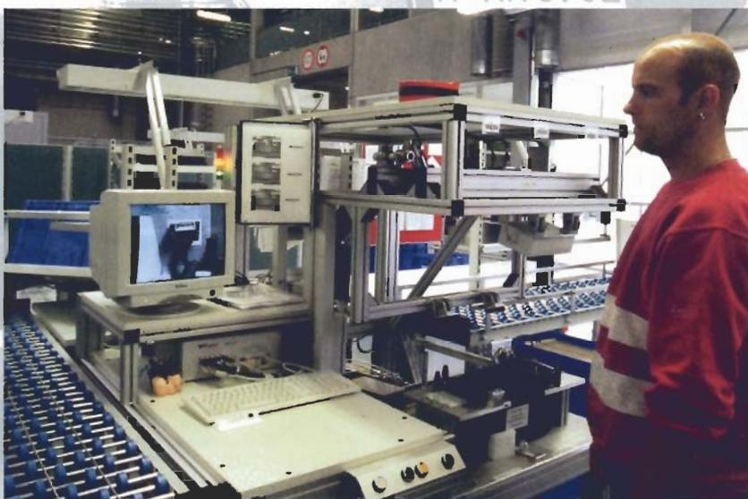
**Hand in Hand: Maschinenbaulich setzt Fischer bevorzugt auf eigene Qualitäten. Für die Integration des Bildverarbeitungssystems – und hier insbesondere die Platzierung der Kameras und IR-Beleuchtungskörper – steuerte visicontrol BV-Technik und Know-how bei.**
