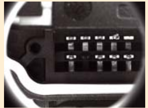
Steckverbinder in Matrix-Form mit unterschiedlichen Pins; die Beleuchtung wurde angepasst, um Defekte zu inspizieren
