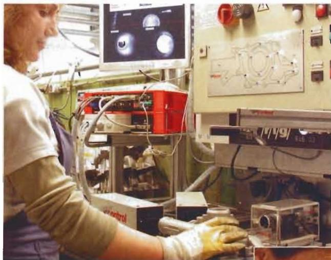
**Bei der Ritter Leichtmetallguss (kurz: rlg) ist Qualität das oberste Gebot. Für die 100%-Kontrolle setzen die Strümpfelbacher unter anderem auf selbst entwickelte und gebaute Handprüfplätze, und dabei seit Ende 2002 auch auf Bildverarbeitungssysteme und das Applikations-Know-how von visicontrol, Weingarten.**
