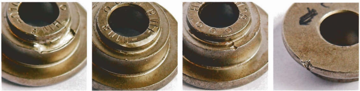
Solche Oberflächen- und Geometriefehler und Maßabweichungen werden von den Kunden nicht akzeptiert
